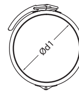
Abrazadera de unión con junta de goma
