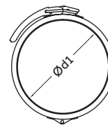
Abrazadera de unión con junta de goma
